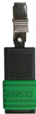
Badge en position ouverte (prélèvement en cours)
