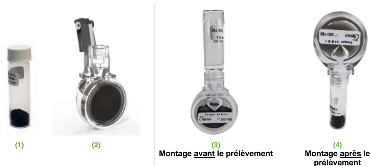
Les éléments constituant les badges G.A.B.I.E. (flacon + corps rond) sont réceptionnés au laboratoire dans leur sachet en plastique d'origine et sont **conservés à température ambiante et à l'abri de la lumière**. Ils sont ensuite placés dans une pochette en aluminium avec fermeture zip pour l'envoi au client.
